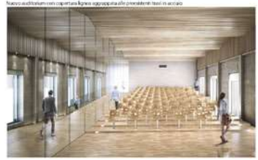
Nuovo auditorium con copertura lignea appoggiata alle precedenti travi in acciaio
