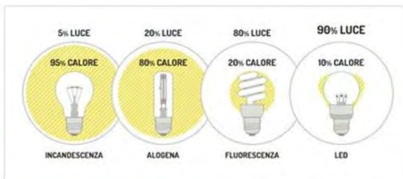
Confronto in termini di efficienza tra le principali lampade presenti sul mercato
