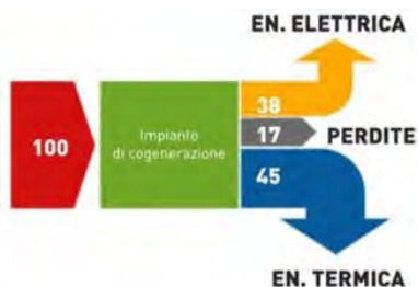
Schema funzionale di un impianto cogenerativo
